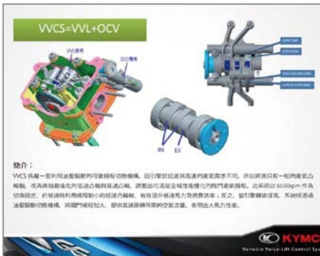
VVCS機構安裝於汽缸頭機油通道上, 藉由控制油壓來推動切換高低速凸輪
